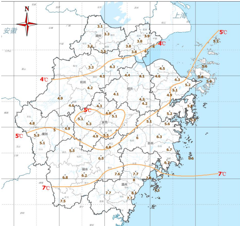
图 B. 2.3 浙江省 2013-2014 年最冷月平均气温分布图 (°C)
