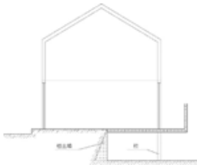
图 5-4 坡地建筑的吊脚架空层
