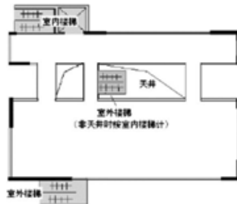
图 5-6 室内室外楼梯
