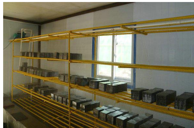
工地养护室实例图
