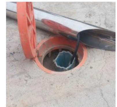
测斜管保护实例图
