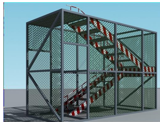
定型化可拆卸的梯笼示意图
