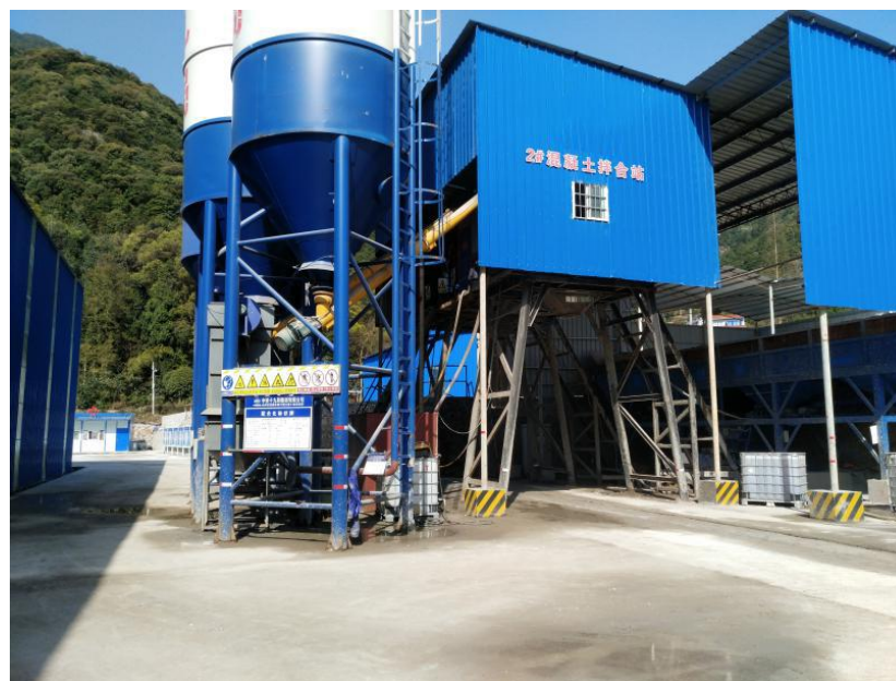
混凝土拌和系统实例图
