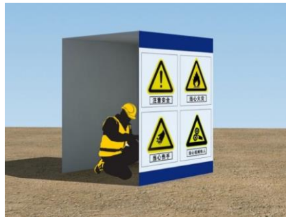
电焊炫光遮挡示意图
