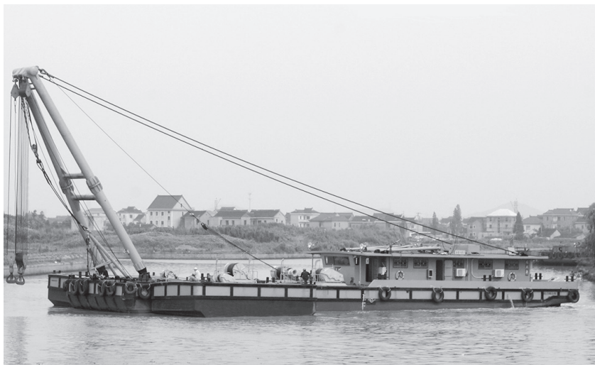
绍兴市引进的120吨起重打捞船
