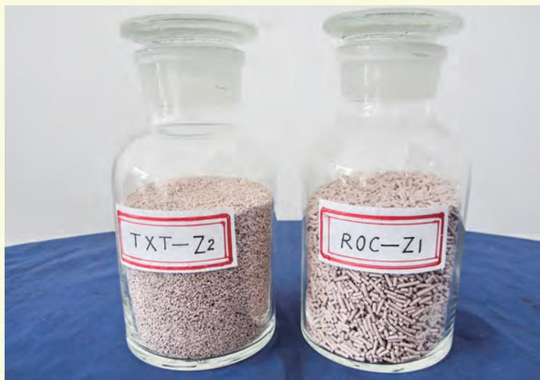
图 131 该产品系杭州永盛催化剂有限公司制造,主要用于石油工业处理烯烃、高聚环基化合物及杂质。
