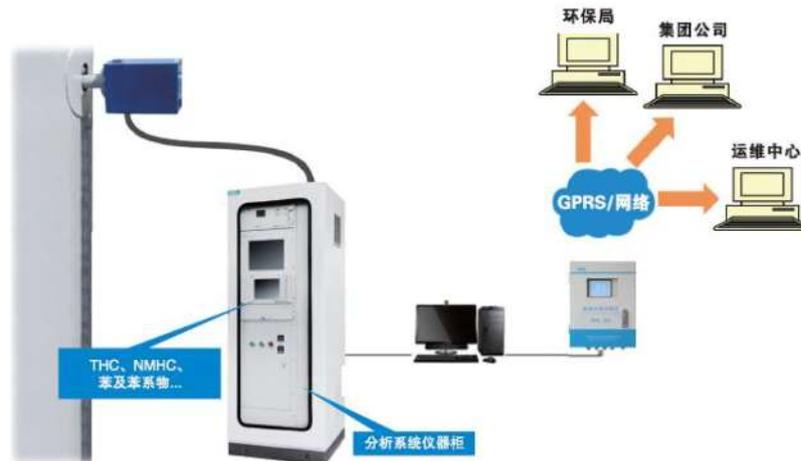
图 4.2-3 废气在线监测系统示意图
