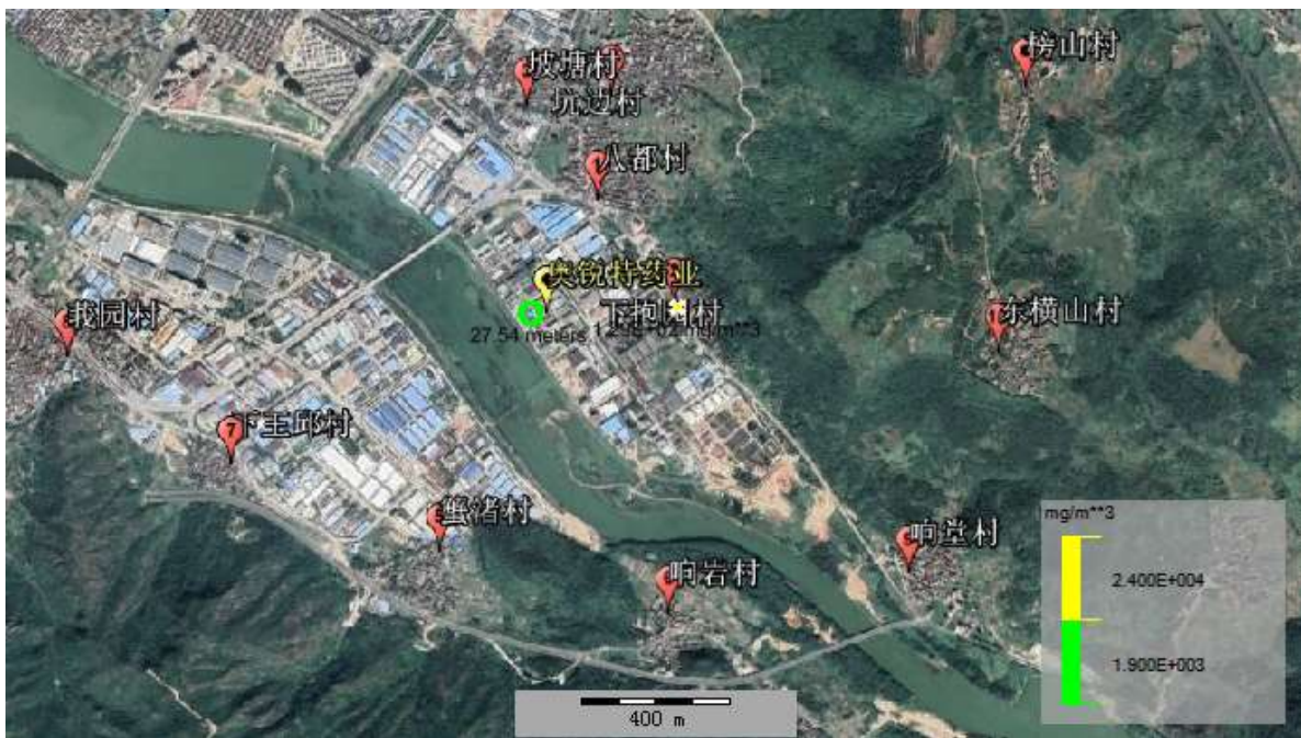
图 6.3-3 二氯甲烷储罐泄漏影响预测图
