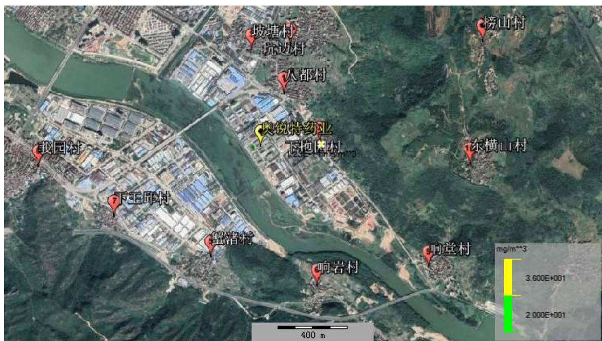
图 6.3-6 氢氟酸储罐泄漏影响预测图
