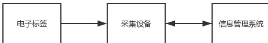
图 4.2.2 瓶装液化气信息管理架构图
